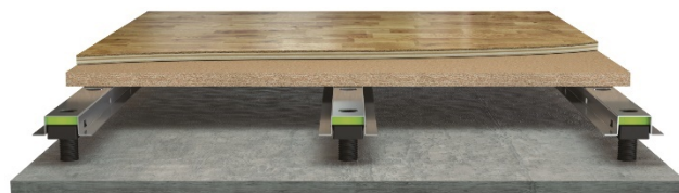
Fig. 2 Granab tilfarersystem, versjon 3000N12 (12 mm dempelement). Prinsipptegning av versjon 3000N med montert 22 mm golvspanplate og hulrom for eventuell føring av installasjoner.
